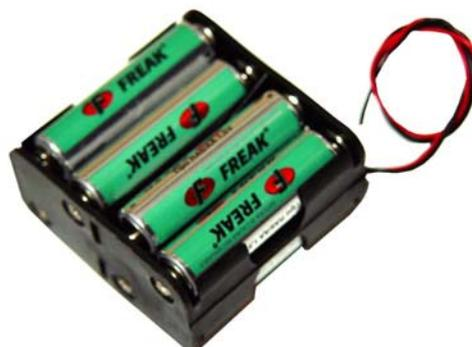
Figura AN2-14. Alimentación del PICBOT-3 mediante un pack de 8 baterías
