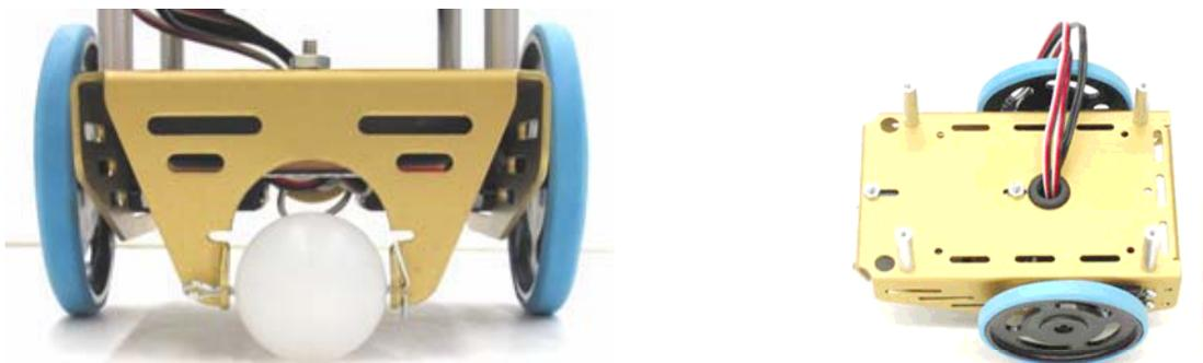
**Figura 4-8.-** A la izquierda imagen de la rueda trasera. A la derecha las dos ruedas motrices delanteras acopladas a los ejes de los servos.
