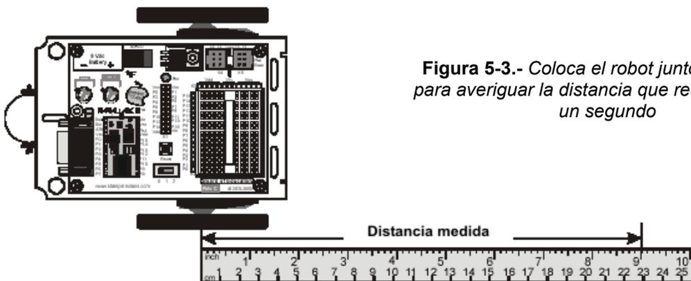
Figura 5-3.- Coloca el robot junto a un metro para averiguar la distancia que recorre durante un segundo
