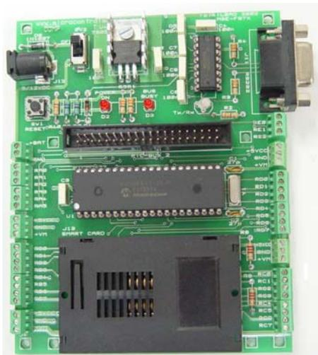
**Figura 1-4.-** Una tarjeta con un microcontrolador programado para realizar una tarea.
