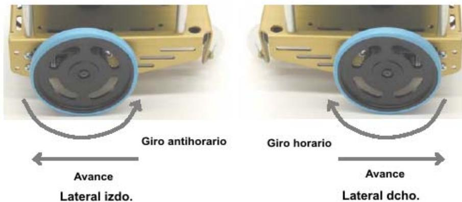
Figura 5-2.- Movimientos contrarios de las ruedas izquierda y derecha cuando avanza el robot.
