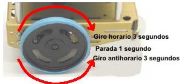
Figura 4-14.- Efecto del programa para la comprobación de la rueda izquierda
