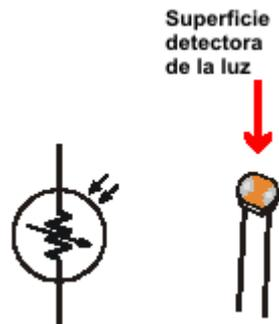
Figura 7-1.- Símbolo eléctrico y apariencia de una LDR, que es una resistencia cuyo valor depende de la luz que recibe.
