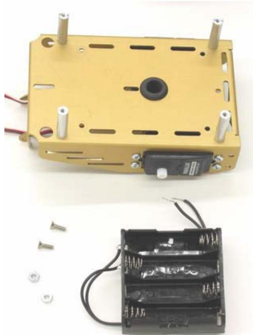
**Figura 4-5.-** Materiales necesarios para sujetar el porta pilas que alimentará a los servos.
