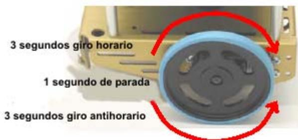
**Figura 4-13.-** El programa de comprobación de la rueda derecha la hace girar 3 segundos en un sentido, luego se para un segundo y finalmente gira en sentido contrario otros tres segundos.
