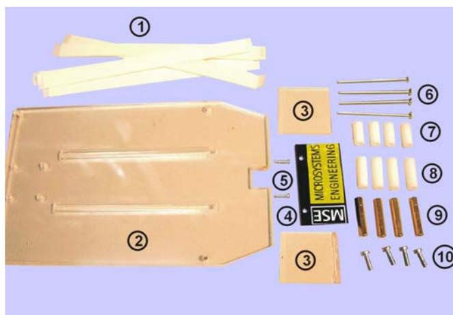
**Figura AN2-7.** Componentes que conforman la estructura del PICBOT-3
