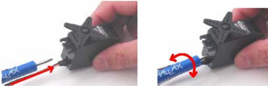
Figura 3-11.- Mueve cuidadosamente el potenciómetro del servo con un pequeño destornillador de cabeza plana hasta que deje de girar, cuando está recibiendo la señal de calibración.
