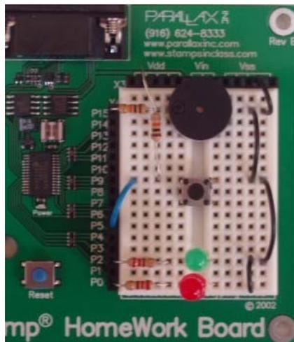
**Figura 2-41.** Fotografía del montaje del semáforo sonoro sobre la Home Work
