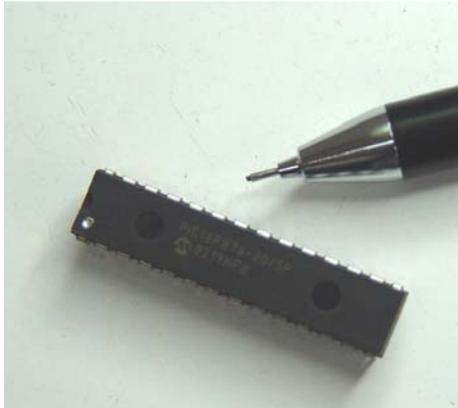
**Figura 1-1.-** Un microcontrolador es un circuito integrado en cuyo interior hay un computador.
