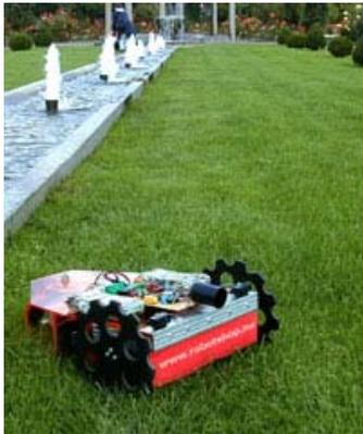
Figura 1-11.- Un microbot corta-césped.
