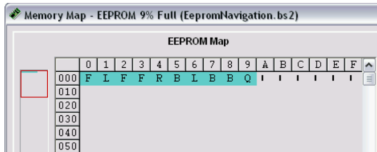
Figura 4-8 Sección del Mapa EEPROM detallado luego de marcar el recuadro "Display ASCII Box"
