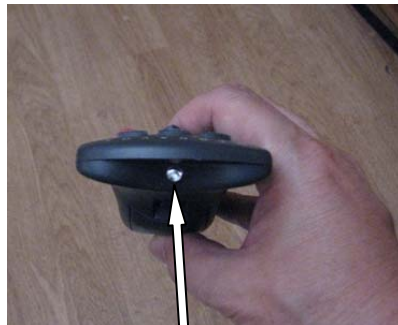
Con un botón presionado, el LED IR no se ve diferente.
