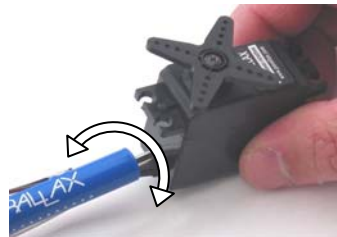
Figura 2-24 ajuste del centro del Servo
