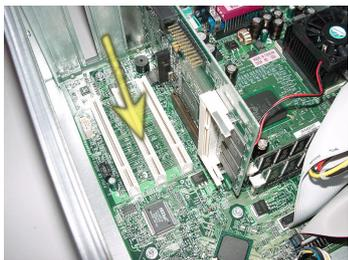
A continuación muestra el lugar para la instalación de la MotiCap L3xx en el lugar del ordenador PC1, al cual debe insertarse y conectarse dicha tarjeta.
