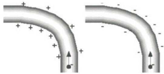
Figura 6 - Las cargas superficiales en los codos del circuito se distribuyen como se muestra en la figura para producir en el interior del hilo el campo adecuado para que los electrones de conducción contorneen el hilo.
