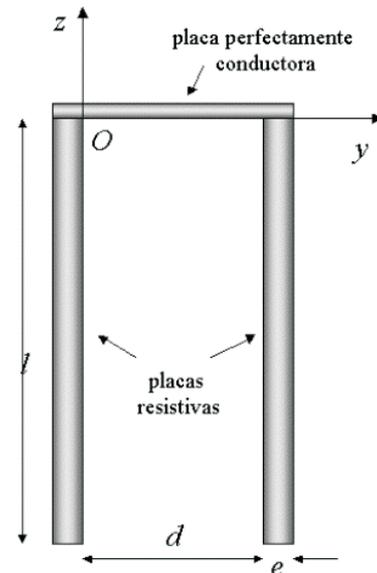
Figura 2 - Dos placas resistivas paralelas, unidas en  $z = 0$  por una placa perfectamente resistiva.
