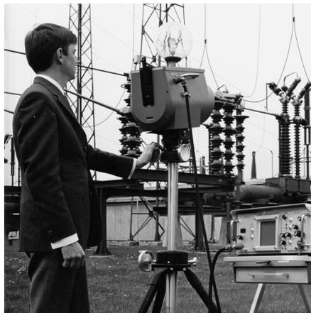
1969: Thermovision, modelo 661. La cámara pesaba unos 25 kg; el osciloscopio, 20 kg; y el trípode, 15 kg. El usuario también necesitaba un generador de 220 V CA y un recipiente de 10 litros con nitrógeno líquido. A la izquierda del osciloscopio se puede observar el accesorio Polaroid (6 kg).
